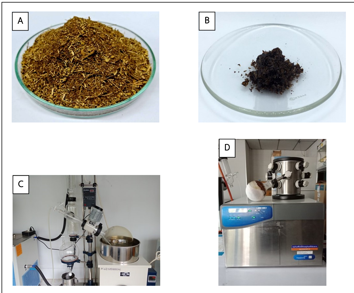
รูปที่ 3 ลักษณะของผงยาปลุกไฟธาตุบดหยาบ (A) สารสกัด 50% แอลกอฮอล์จากยาปลุกไฟธาตุ (B) การระเหยตัวทำละลายด้วย Rotary Evaporator (C) และการทำให้สารสกัดแห้งด้วยเครื่อง Freeze Dryer (D)
